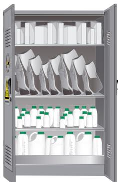
**Nel caso di quantità ridotte si può utilizzare un armadio apposito, dotato di griglie per il passaggio dell'aria.**
